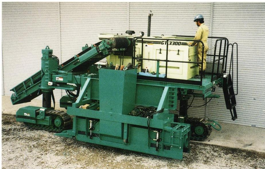
ゴメコ社のベスト・セラー「コマンダーⅢ」の弟で、2.6×2.6×6.0m、重量9tと、体もコンパクトなスリップフォーム機械です。縁石、ガッター、直壁（1m）、側溝、円形水路など任意の形状を、モールドを交換するだけで施工できます。
